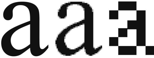
Visualización de una misma tipografía, en forma impresa y en pantalla (con suavizado de bordes y con proceso de hinting para cuerpo muy pequeño).
